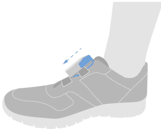
Figura 4-5: Colocación del Sensor.
